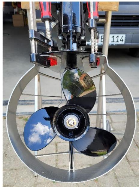
7. Kontrollieren Sie, ob der Propellerschutz richtig sitzt. Der Propeller darf an keiner Stelle den Propellerschutz berühren. Rechts und links muss der Abstand zum Propellerschutz gleich sein.
