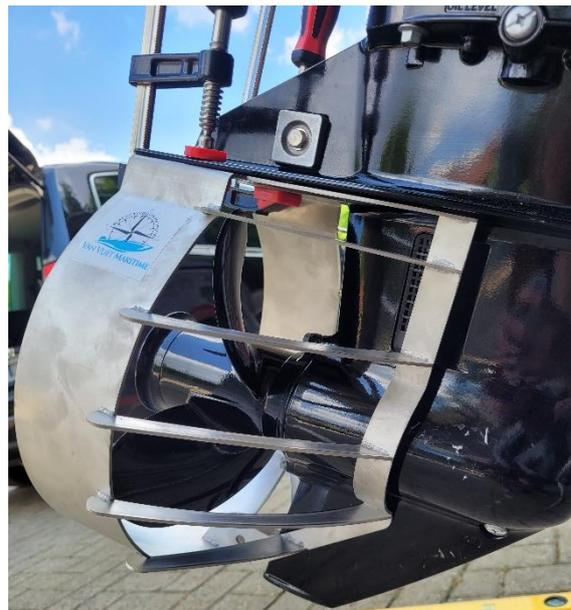
3. Wenn der Propellerschutz mittig ausgerichtet ist, markieren Sie die vier Bohrlöcher an der Anit-Kavitationsplatte. Entfernen Sie den Propellerschutz anschließend vom Motor.
